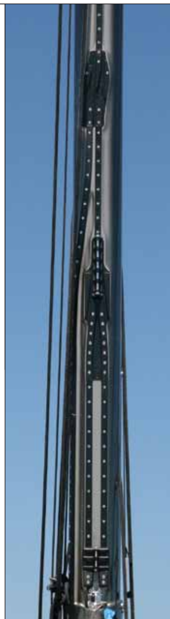
System zwrotnicy trajsla oraz grota wykorzystuje jedną szynę w celu obniżenia wagi.
