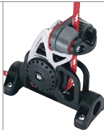
Bloczek obraca się wokół osi liny utrzymując ją blisko przy pokładzie.
